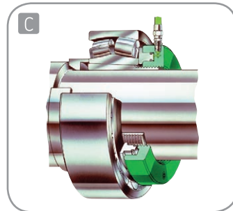
C HMV ..Eナットで軸受をアダプタースリーブに押し込む D HMV ..Eナットと専用ストップナットで取外しスリーブを引き抜く
