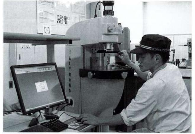
**品質検査** 表面形状、寸法精度、硬さ、音響などを検査し、「ツバキ・ナカシマ」ブランドの徹底した品質保証が行われます。
