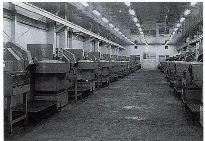
**グラインディング** 熱処理のあと、鋼球の研削を行い、鋼球表面の荒仕上げを行います。
