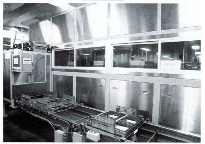
**洗 浄** 超音波洗浄機で鋼球に付着した汚れを除去します。
