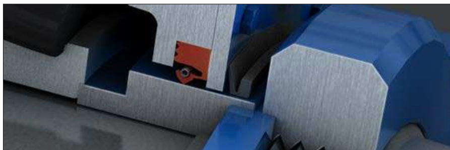
ロータリーシャフトシールの基本機能 - 潤滑剤を保持しながら異物の機器内部への浸入を防止し、潤滑剤を保持することで軸受を保護する役割を果たします。
