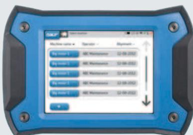
マシンライブラリーにより、すべての機械の概要とアライメントレポートが表示されます。
