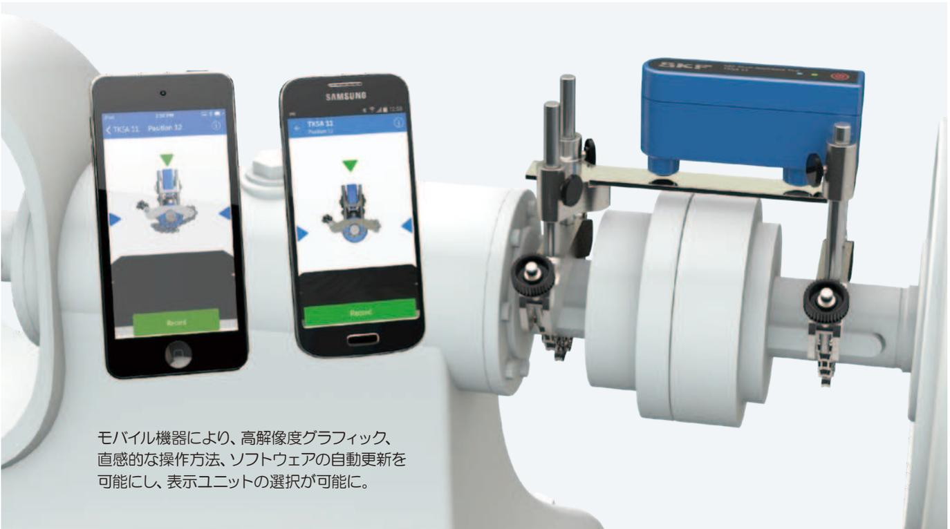
モバイル機器により、高解像度グラフィック、直感的な操作方法、ソフトウェアの自動更新を可能にし、表示ユニットの選択が可能に。
