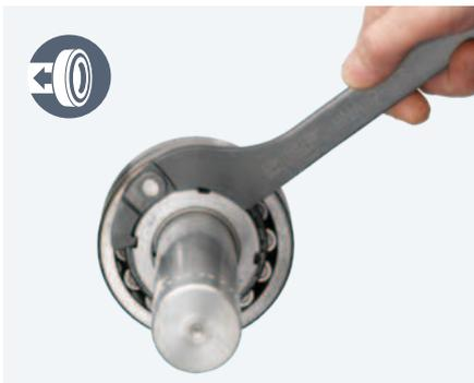
4種類で最大24サイズのナットを締付け、取外し
