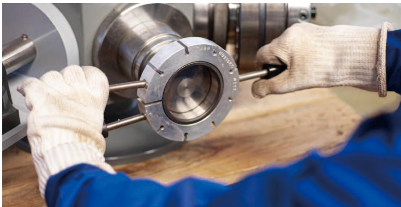
SKFアルミ製加熱リングTMBRシリーズは、特定の軸受内輪に正確に適合するように製造されます。ご注文の詳細が記載された以下の表から、特定の軸受型番に適したTMBRを簡単に見つけることができます。
