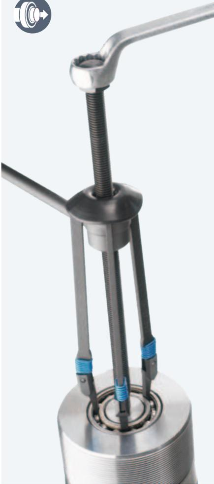
最適化されたプーラーの爪形状は、軸受保持器を取り外すことなく、SKF軸受の外輪軌道面をしっかりと掴みます。
