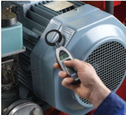
電動モーターが可変周波数運転システムによって制御されている場合、軸受は放電による電食を受けやすくなります。放電チェックペンを予知保全プログラムの一環として使用することで、不具合が起こりそうな軸受を検知し、予期しない機械のダウンタイムを大幅に防ぐことができます。
