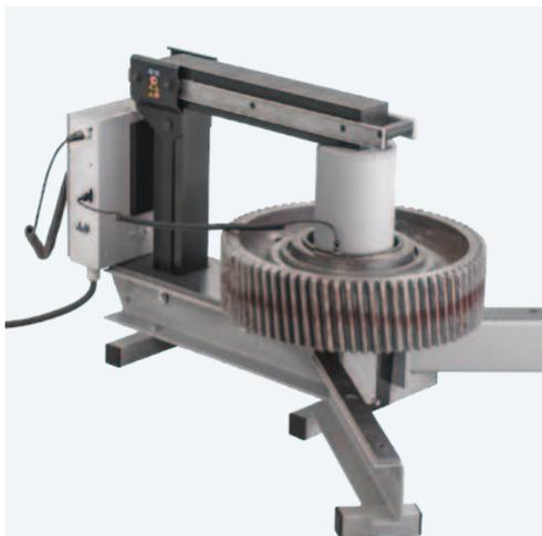
TIH L MBは、機種により最大600 kgの軸受以外の部品を加熱します。
