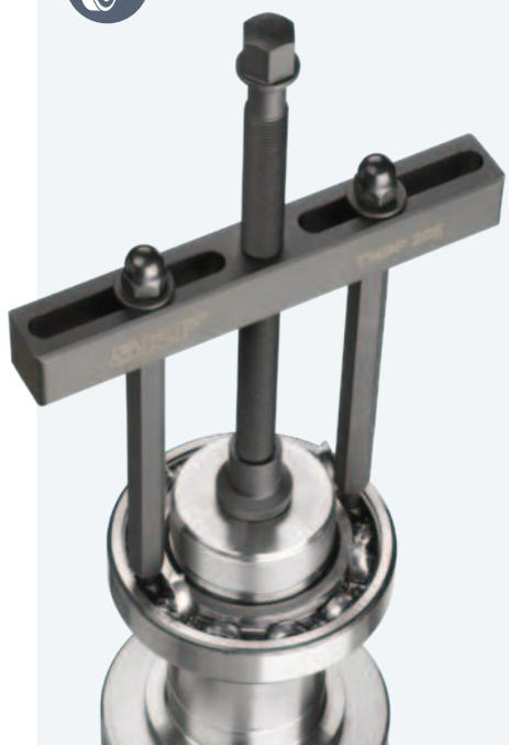
機械を分解せずに軸受を取り外す
