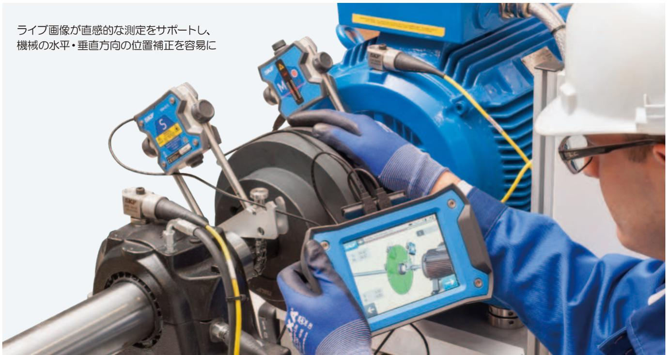
測定とレポート機能を強化した最先端レーザー式シャフトアライメントシステム
